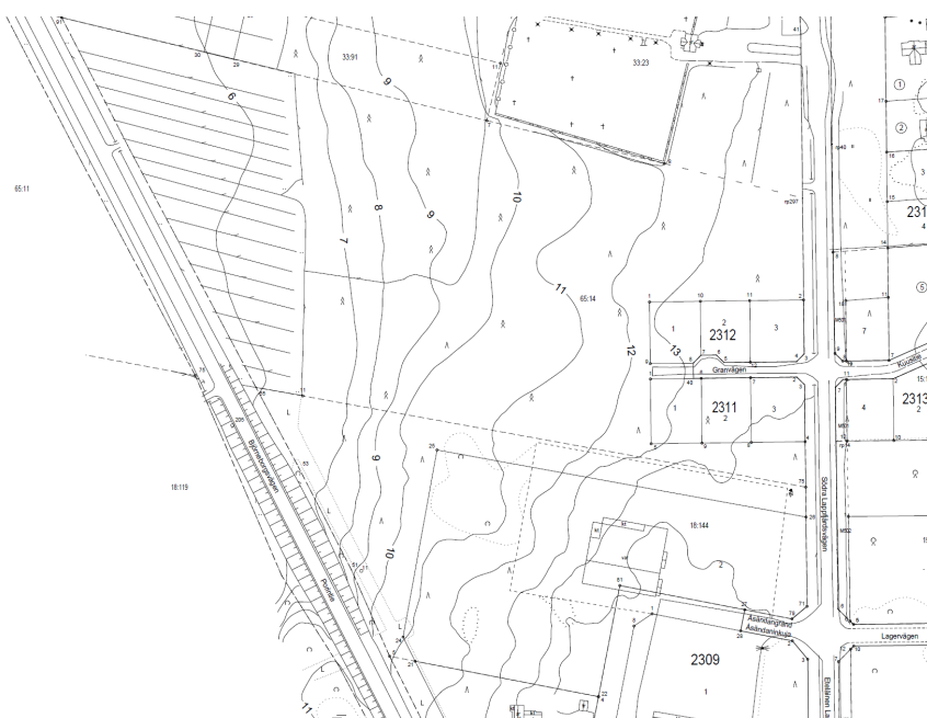
Bild 5. Utdrag ur baskartan. Med hjälp av höjdkurvorna ser man hur området sluttar mot väst.
